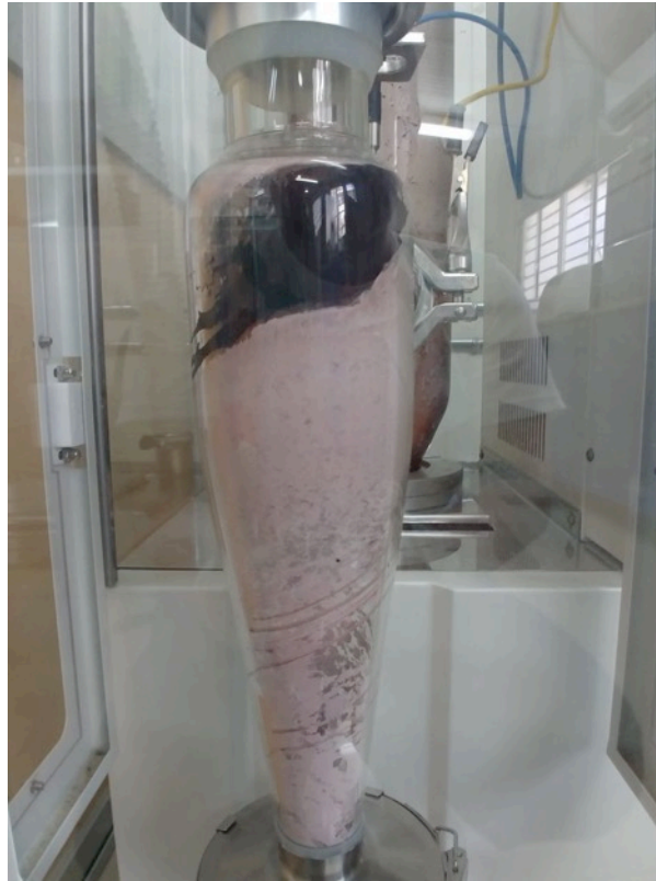
Figura 19. Producto de secado por aspersion del hongo M. anisopliae .
