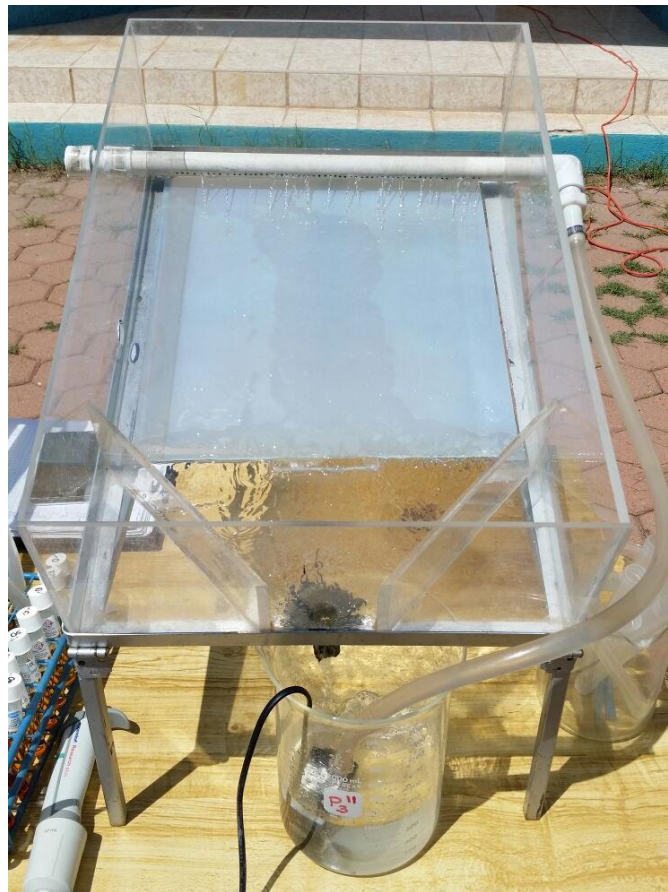
Figura 11 Reactor y placa de vidrio utilizado en los procesos solares
