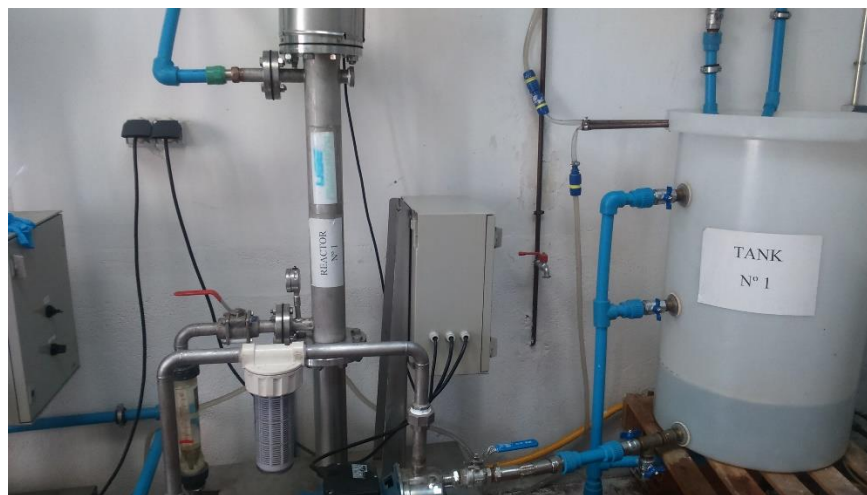
Figura 17 Sistema de tratamiento usado en la experimentación con radiación UV-C
