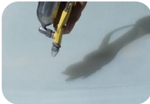
Figura 13 Aspersion de la solución de fotocatalizador sobre la placa de vidrio
