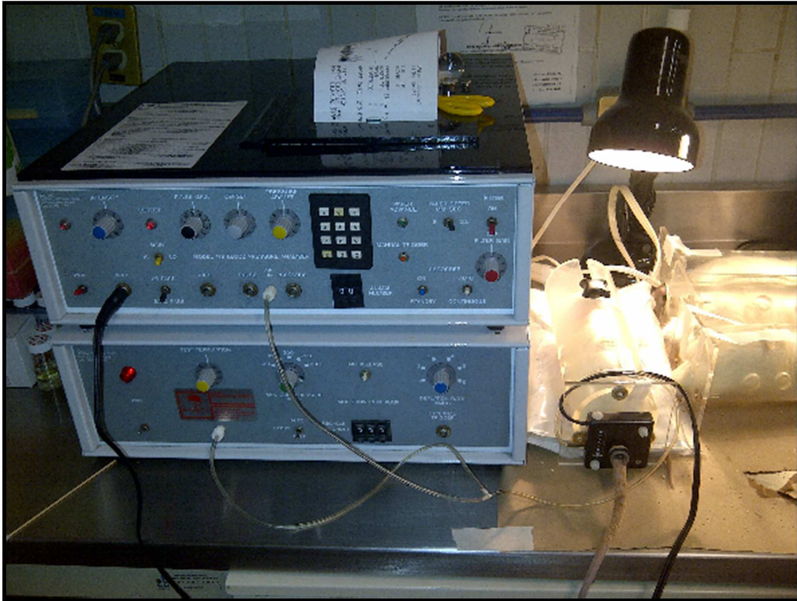
Figura 7. Escenario durante el ensayo a largo plazo (no invasivo) en ratas SHR. Se observa la cola de la rata en la medición de su presión arterial dentro de una cámara plestimógrafa y conectada al dispositivo traductor de señal, dando como resultado la PAS graficada.
